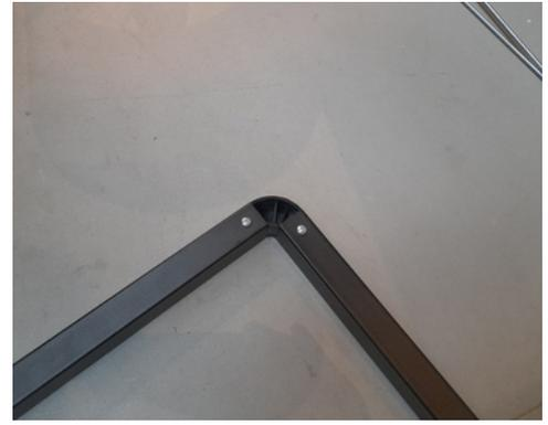
Fixez maintenant les coins avec des vis. Commencez par les deux coins arrière en utilisant un tournevis ou une perceuse-visseuse. Une fois les deux coins arrière solidement vissés, fixez d'abord la traverse du cadre à l'arrière, avant de sécuriser les deux coins avant avec des vis.
