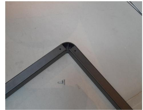
Assemblez maintenant le cadre à l'aide des connecteurs d'angle ronds. Emboîtez d'abord les quatre coins sans les fixer immédiatement avec les vis. Cette étape sera réalisée par la suite.
