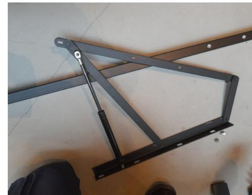
Nehmen Sie nun eine der beiden Gasfedern und klappen Sie sie aus. Befestigen Sie nun die Gasfeder zwischen den beiden. Befestigen Sie den Flachkopf mit einer Schraube und stecken Sie von unten eine Schraube durch das andere Ende der Gasfeder.
