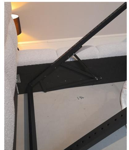
Auch dieser Schritt ist mit zwei Personen einfacher. Während eine Person den Rahmen hochhält, kann die andere die mitgelieferten Schrauben von Hand in die vier Schraublöcher im Bettrahmen eindrehen. Ziehen Sie diese dann mit einem Schraubenzieher oder Schraubendreher fest. Wiederholen Sie den Vorgang für das andere Gasfedersystem. Der Rahmen des Lattenrostes ist nun am Bettrahmen befestigt. Der Rahmen bleibt nun automatisch oben.
