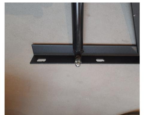
Wenn die Schraube hier herausragt, schieben Sie die Mutter über sie. Schieben Sie dann die Abdeckmutter über die Schraube und ziehen Sie sie mit einer Stecknuss oder einem Steckschlüssel fest.
