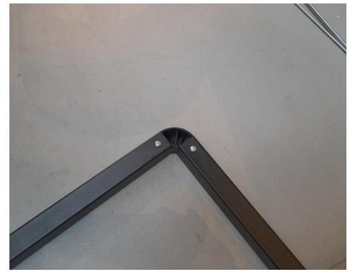
Befestigen Sie nun die Ecken mit Schrauben. Beginnen Sie mit den beiden hinteren Ecken, indem Sie einen Schraubenzieher oder einen Akkubohrer verwenden. Wenn die beiden hinteren Ecken festgeschraubt sind, befestigen Sie zuerst das Zwischenstück des Rahmens an der Rückseite, bevor Sie die beiden vorderen Ecken mit Schrauben sichern.
