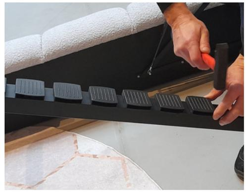
Nehmen Sie nun alle mitgelieferten Befestigungskappen für den Lattenrost und sammeln Sie die Kappen, die auf beiden Seiten eine Öffnung haben. Diese müssen an den Löchern im Mittelsteg des Rahmens befestigt werden. Drücken Sie die Kappen ein und klopfen Sie leicht mit einem Hammer darauf.
