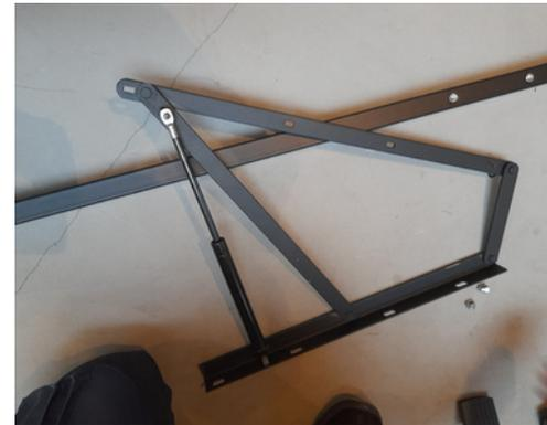
Prenez maintenant l'un des deux vérins à gaz et déployez-le. Fixez le vérin à gaz entre les deux éléments. Fixez la tête plate avec une vis et insérez une vis par le bas à travers l'autre extrémité du vérin à gaz.
